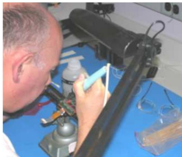
Figura 23. Recuperação do flat cable, SSCVR, PR-GTD
