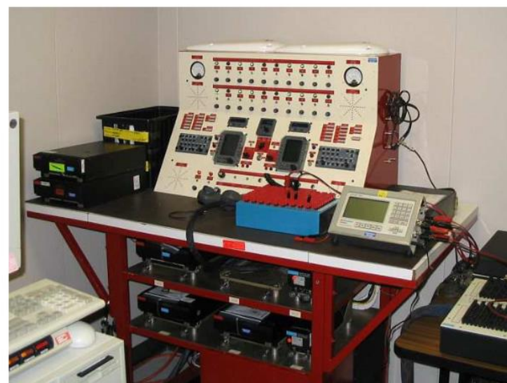
Figura 8. Bancada Primus II (Radio Navegação)
